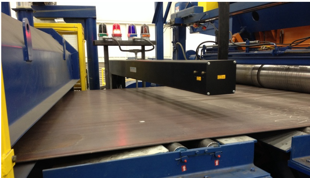
Medidor de espesor AGT800 Instalado en una Línea de 96" de ancho con Stretcher
